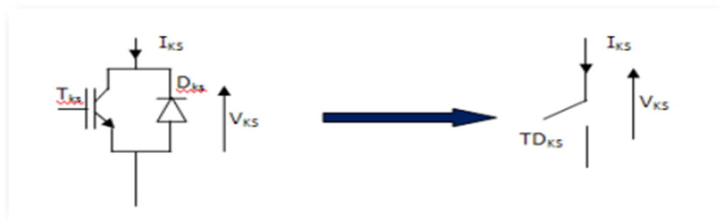
Figure (II.10) : Interrupteur bidirectionnel équivalent de la paire Transistor – diode
